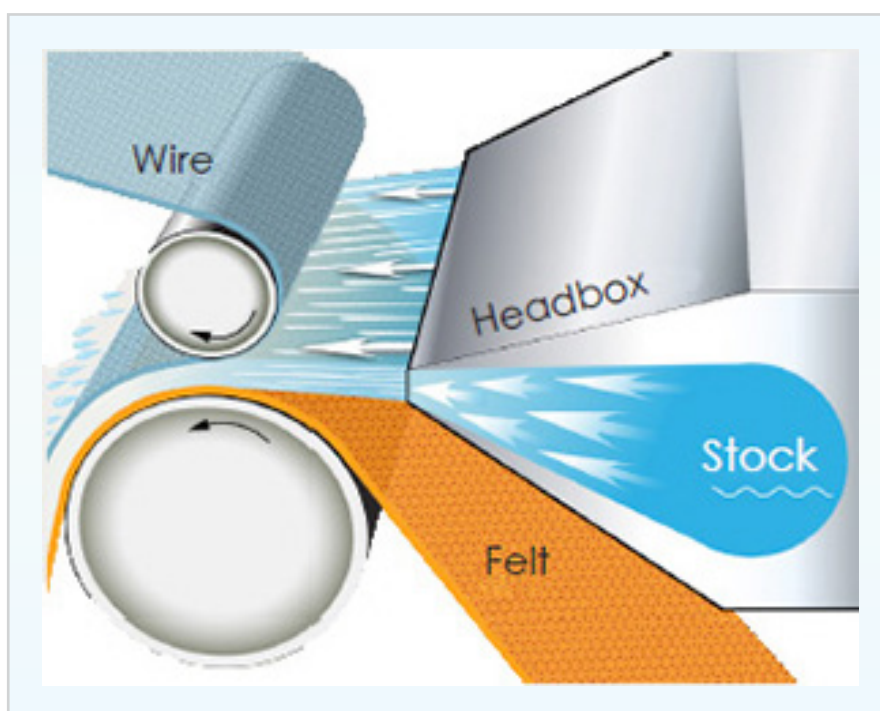
Figura 4: Esquema de caixa de entrada de máquina crescent former (Fonte: Valmet).
